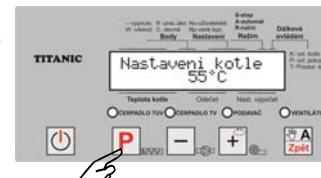
U regulátoru bez zapnutých časových bodů lze změnit zadanou teplotu + a - bez vstupu do konfiguračních parametrů.
