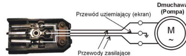
Rys. Podłączenie przewodów od dmuchawy/pompy do wtyczki.
