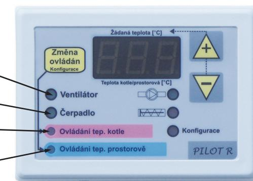
Stisknutím tlačítka [2] se zvolí nastavovaný parametr. Kontrolky zobrazí aktuálně nastavené parametry (viz obrázek výše).
