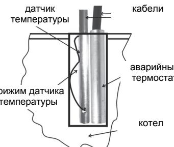
Аварийный термостат или датчик температуры можно смонтировать на неприкрытой выходной из котла ЦО трубе, используя металлический хомут. После начального зажима хомута-согласно рисунка(хомут можно закрутить два раза вокруг трубы, либо обрезать излишки хомута) вставить датчик температуры и аварийный термостат между хомутом и трубой.
