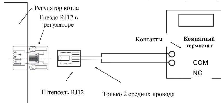
Подключение комнатного термостата имеющего только гнезда COM и NO.
