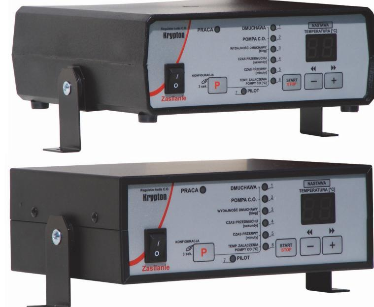
Микропроцессорный регулятор температуры котла центрального отопления (ц.о.) предназначен для управления работой котла ц.о. с вентилятором. Регулятор стабилизирует температуру котла с помощью плавной регулировки оборотов вентилятора, производит наддув в котел (с целью ликвидации накопленных газов, образовавшихся в результате процесса сгорания) и защищает систему центрального отопления от закипания воды. Регулятор управляет работой насоса центрального отопления.
