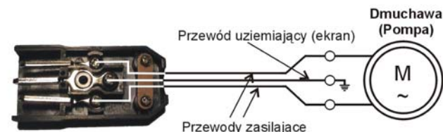
Rys. Podłączenie przewodów od dmuchawy/pompy do wtyczki
