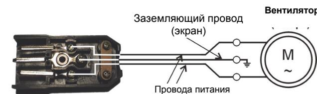
Рис. Подсоединение проводов от вентилятора к вилке
