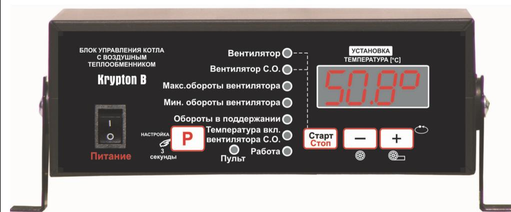
Микропроцессорный регулятор температуры котла центрального отопления (ц.о) с воздушным теплообменником и вентилятором камеры сгорания; Регулятор стабилизирует температуру котла с помощью плавной регулировки оборотов вентилятора (алгоритм PID). **Krypton B** управляет работой вентилятора системы отопления (**Вентилятора Ц.О.**)
