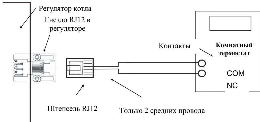
Подключение комнатного терmostата имеющего **только** гнезда COM и NO.
