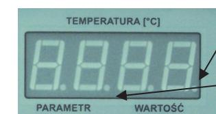
migająca kropka oznacza osiągnięcie temperatury zadanej
